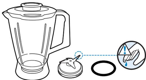
**PT** Copo do liquidificador com tampa, trava e unidade de lâminas destacável com anel de vedação (RI7625 somente).
