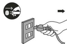
Desligue imediatamente o aparelho se o plug do cabo de força não estiver inserido totalmente na tomada.
