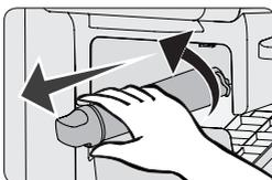
Para garantir a melhor filtragem possível da água, a troca do filtro deve ocorrer no máximo ao final de sua vida útil, 6 meses de uso ou 757 litros, ou quando o indicador de filtro saturado se acender no painel. Se o refrigerador ficar desligado por um longo período (como em uma mudança, por exemplo), troque o filtro antes de reinstalar o refrigerador.
