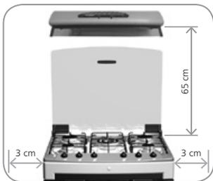
O local de instalação do modelo convencional (piso) deve prever uma distância mínima de 3 cm em toda a volta do fogão para circulação de ar e um vão superior de 65 cm de altura em relação à mesa para permitir a abertura da tampa de vidro.
