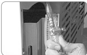
1. Coloque a braçadeira de metal em uma das pontas da mangueira. Em seguida, encaixe a mangueira no ponto de entrada de gás.
