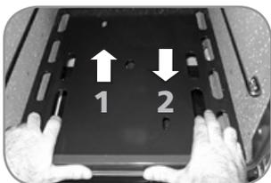
1. Deslizar o chão móvel pelas laterais do Forno até encostar na parte traseira.
