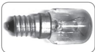
Utilize somente lâmpadas de 25 W e com rosca E14, cujo uso seja recomendado para fogões. **ATENÇÃO:** Assegure-se de que o aparelho está desligado antes de substituir a lâmpada, para evitar a possibilidade de choque elétrico. Para instalar/trocar a lâmpada do forno, siga as instruções da página 42.
