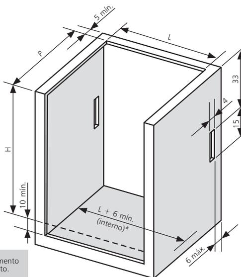
\* Esta dimensão é importante para garantir um afastamento mínimo e simétrico entre a parede do móvel e o produto.
