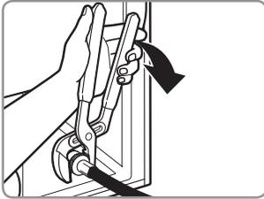
6. Aperte todas as conexões com o alicate, girando dois terços de volta adicional.
