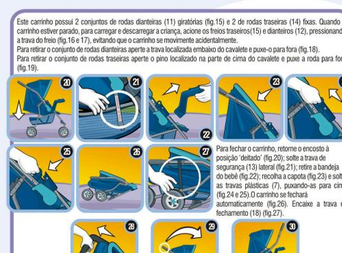
Este carrinho possui cabo reversível. Para reverter o cabo, puxe com os dedos para cima o puxador de reversão do cabo (19), localizado abaixo do cabo (fig. 28) e empurre-o para frente do carrinho até ouvir um "click" (fig. 29). Certifique-se que esteja travado (fig. 30). Para voltar à posição traseira, repita o processo em ordem inversa.
