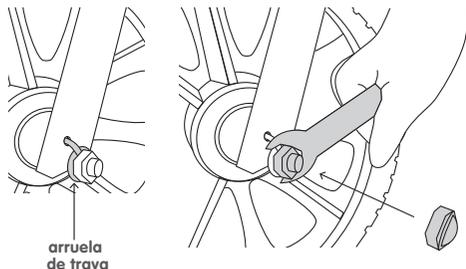
Encaixe a roda dianteira no garfo, coloque a arruela de trava no local indicado e aperte a porca (17-20Nm). Após o aperto, insira a proteção plástica.
