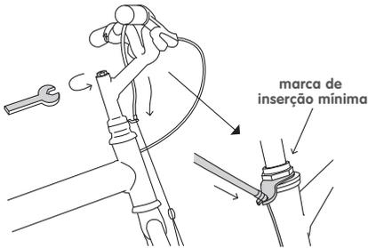
Insira o guidão no cabeçote e aperte a porca do guidão com a ferramenta indicada (17-20Nm). Em seguida, encaixe o conduíte de freio no suporte de conduíte.
