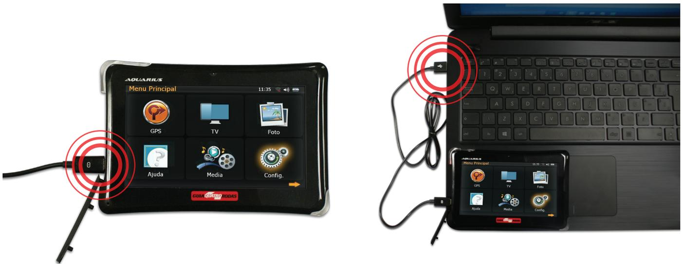
**6º passo:** conecte a outra extremidade do cabo numa porta USB do computador para que recarregue e utilize o GPS normalmente. Para que o GPS funcione normalmente enquanto conectado ao computador para manutenção do nível de bateria, é necessário que já tenha sido realizada a recarga mínima de 8 (oito) horas.
