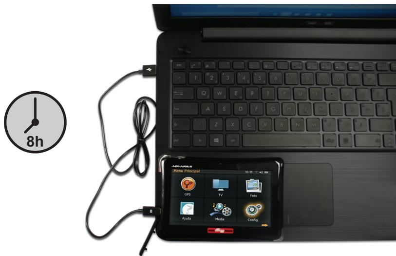
**3º passo:** após o término da recarga de bateria por 8 (oito) horas, desconecte o cabo USB do GPS e ligue o produto pressionando o botão "power".
