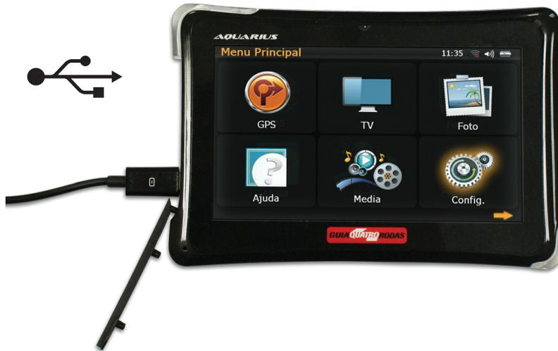
**2º passo:** conecte a outra extremidade do cabo numa porta USB de um computador, deixando o produto em recarga de bateria durante 8 (oito) horas. Durante este tempo, certifique-se que o GPS permaneça desligado e o computador esteja ligado e não entre em modo de espera ou stand by.
