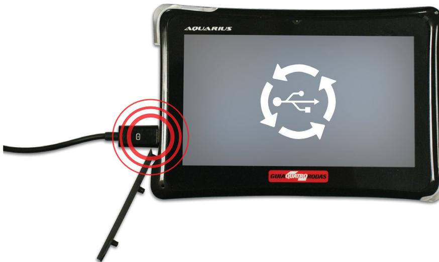
**7º passo:** conecte a outra extremidade do cabo numa porta USB do computador e navegue entre as pastas do GPS normalmente, como se fosse um pen drive.
