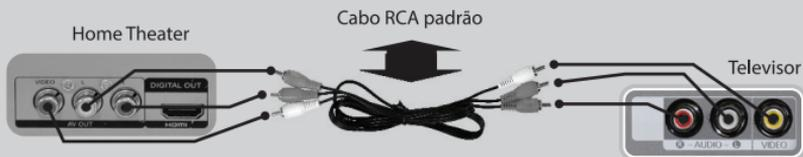
faça coincidir as cores do plug com as cores das saídas e entradas.
