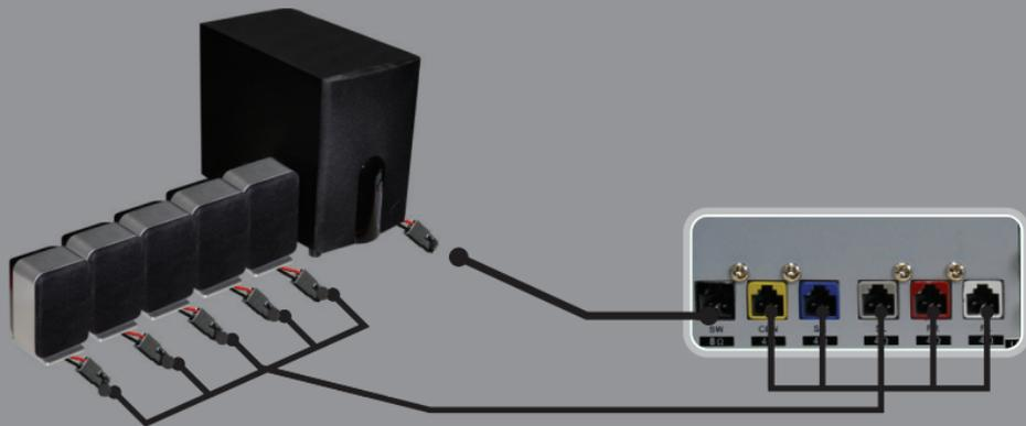
faça coincidir as cores dos conectores com as cores das saídas do amplificador
