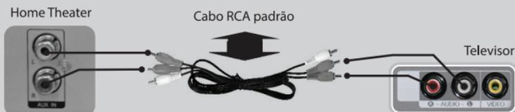
faça coincidir as cores do plug com as cores das saídas e entradas.
