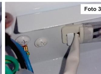
3º - Desencaixe a lâmpada de led junto a eletro-calha, endireitando a "presilha" que a fixa (**Foto 3**);
