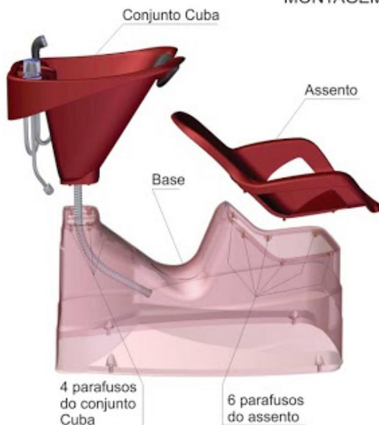
1- Montar Conjunto Cuba com os registros, mangueira, aquecedor (se houver), ducha, conduto de saída d'água conforme figuras acima.
