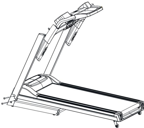
**Passo 3:** Coloque a barra de apoio na posição horizontal (como mostra o desenho) e em seguida prenda o console à coluna vertical com dois parafusos Cab. Aba. Sext. Interno M8\*15. (Trave os parafusos)
