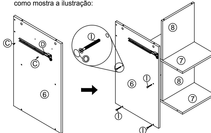
3º Fixe a Corrediça (D) com os parafusos (C) e as arruelas (Q) na Lateral nº4 para em seguida fixá-la na peça nº11 com os parafusos (L), como mostra a ilustração:
