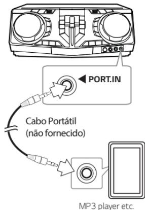
Na unidade, conecte seu dispositivo portátil (MP3 player e etc.) à conexão **PORT. IN** usando um cabo portátil (**Tipo P2**).
