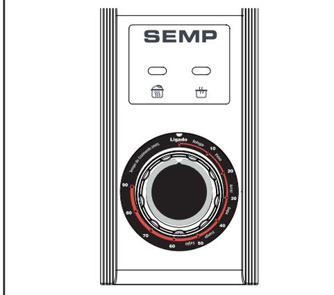
7. Ao término do preparo a panela voltará para o modo aquecer automaticamente. Para sua segurança, a tampa permanecerá travada enquanto houver pressão na panela. Quando a pressão for totalmente aliviada, a Válvula Flutuante abaixará, indicando que a panela já pode ser aberta.
