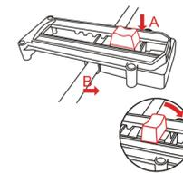
Para ajustar a altura da bandeja superior vire a manivela da trava para destravar. Em seguida mova o tubo, a bandeja irá descer. Quando a bandeja atingir a altura desejada, vire a manivela para travar novamente.
