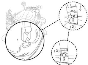
Coloque a base no chão e encaixe a parte de baixo dos suportes nos orifícios (figura 1). Para ajustar a altura aperte os botões (2) e empurre até chegar a altura desejada (3).
