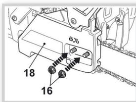
Instale novamente a cobertura da corrente de forma que os parafusos estejam encaixados nos orifícios. Parafuse novamente as porcas com a mão, sem apertar muito.
