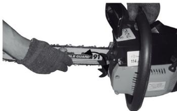
2 - Toque a madeira sem exercer demasiada pressão, pois o corte da madeira deve ocorrer com o movimento da corrente e não com a força do operador. A garra apoio deve ser utilizada como um pivô, apoiando o movimento;
