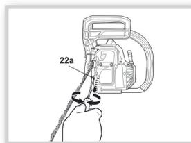
Enquanto segura a ponta do sabre ajuste a tensão da corrente girando o parafuso tensor com a chave de fenda.
