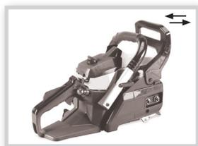
Certifique-se que a alavanca do freio de corrente esteja para trás na posição destravada. Afrouxe e retire as duas porcas e, em seguida, retire a cobertura da corrente.
