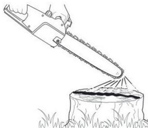
Se porventura o óleo não estiver fluindo pelo sistema, é possível que haja uma obstrução no duto de descarga do óleo. Neste caso, limpe-o com um objeto fino como um clipe ou palito de dentes. Se, ainda assim, o fluxo não for normalizado, você pode ajustar o volume de óleo que circulará pelo duto através do parafuso dosador de fluxo de óleo. No sentido anti-horário, ele aumentará o fluxo de óleo no duto e no sentido horário, ele diminuirá o fluxo.
