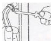
Utilize braçadeiras nas pontas da mangueira para fazer a ligação entre a válvula e a entrada de gás da mesa. Após encaixar a mangueira aperte as braçadeiras utilizando uma chave de fenda ou Phillips.
