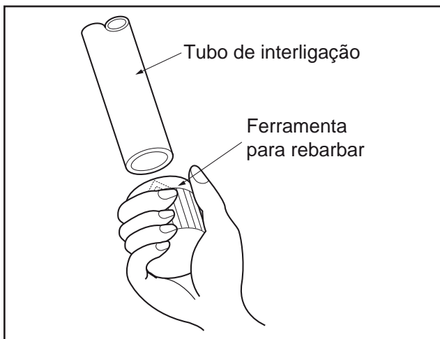
FIGURA 20 - FERRAMENTA PARA REBARBAR
