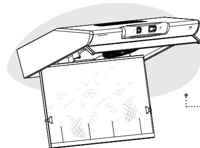
Em seguida retire as travas de arame, fazendo um movimento horizontal para fora. Retire a manta saturada, e em seguida coloque a nova e repita o procedimento anterior para o fechamento da grade.
