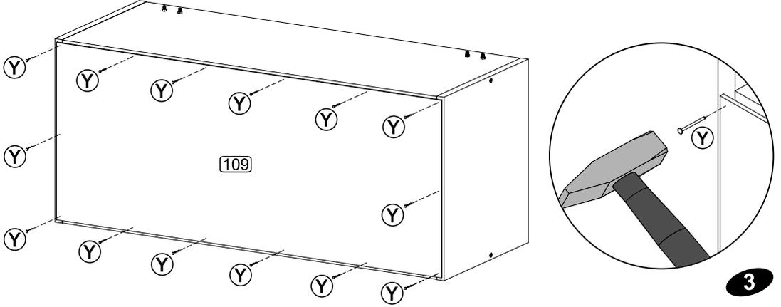
Fixação na Parede/Montaje en la Pared
