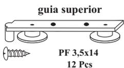
Os parafusos para montagem das Roldanas, estão no subkit junto com as roldanas. ATENÇÃO: O PARAFUSO MAIOR É PARA FIXAR A GUIA SUPERIOR
