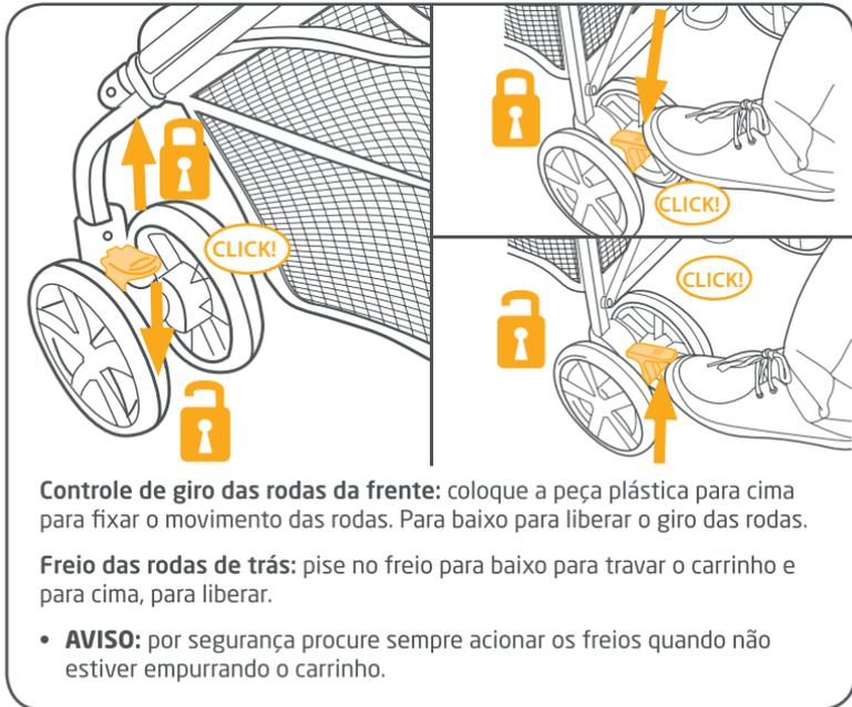
**Controle de giro das rodas da frente:** coloque a peça plástica para cima para fixar o movimento das rodas. Para baixo para liberar o giro das rodas.
