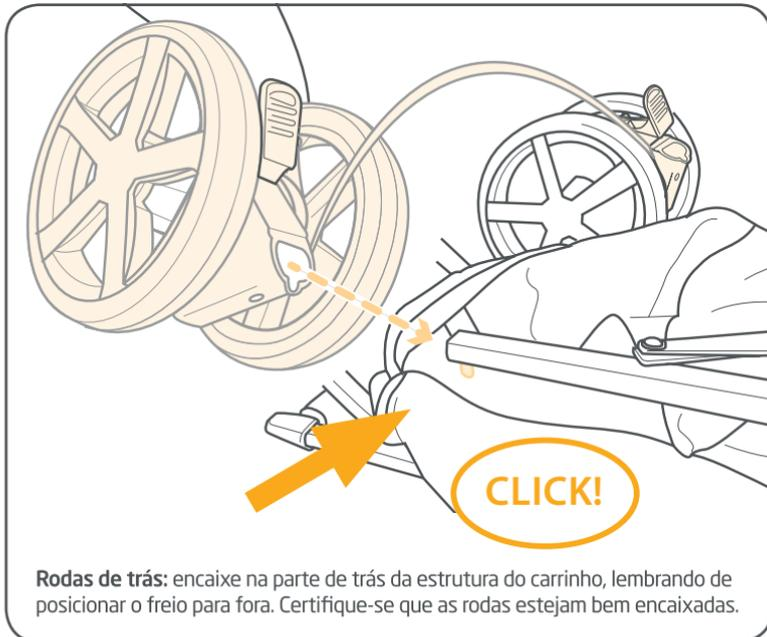
**Rodas de trás:** encaixe na parte de trás da estrutura do carrinho, lembrando de posicionar o freio para fora. Certifique-se que as rodas estejam bem encaixadas.
