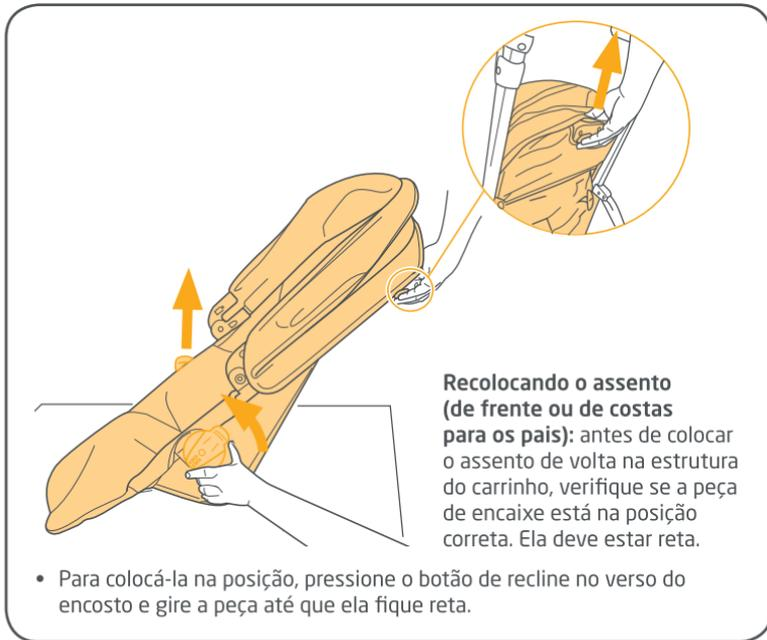
**Recolocando o assento (de frente ou de costas para os pais):** antes de colocar o assento de volta na estrutura do carrinho, verifique se a peça de encaixe está na posição correta. Ela deve estar reta.
