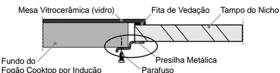
Detalhe instalação da presilha metálica
