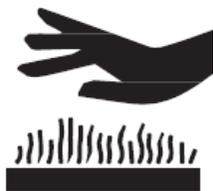
O desenho acima indica superfície aquecida. Não toque no escapamento durante o funcionamento da motosserra ou logo após o uso. O contato com partes aquecidas pode causar sérias queimaduras.
