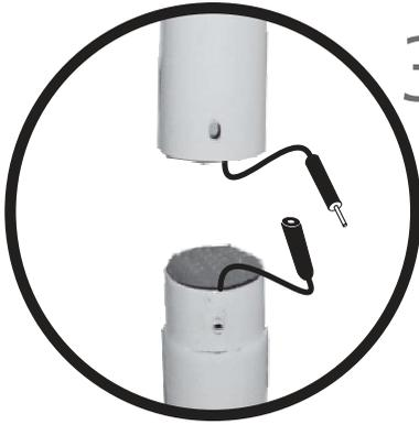
**3** Antes de unir e apertar a coluna do módulo eletrônico, é necessário conectar o cabo do painel e colocá-lo para dentro da coluna.
