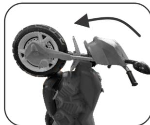
**1.4-** Após encaixar a parte superior, encaixe a parte inferior do garfo na bucha de cachimbo.
