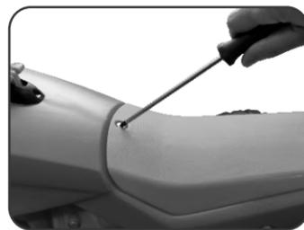
**3.1 -** Remova o parafuso do assento utilizando uma chave Philips (**não inclusa**), em seguida, remova o assento.
