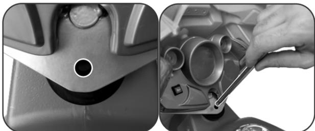
**1.5-** Com as buchas fixadas no cachimbo, alinhe os furos do guidão e buchas. Em seguida, insira o eixo do cachimbo, passando o eixo por todos os furos.
