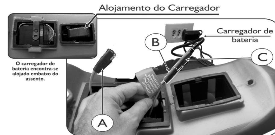
Remova o assento da moto, desencaixe os PLUGS (A) e (B) e encaixe o PLUG do carregador (C) no PLUG (B), localizado no chicote da bateria. A seguir, ligue o carregador na tomada.
