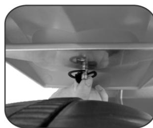
**1.6-** Encaixe a trava plástica no eixo do cachimbo para travar o conjunto, localizado embaixo do paralamas dianteiro.
