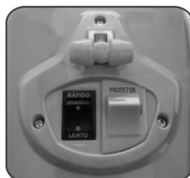
O Botão Rápido/Lento possui uma tampa de proteção. Para utilização na posição "rápido", é necessário remover a tampa.
