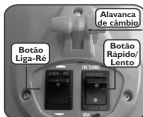
**3.6 -** A marcha a ré só funciona com a chave Rápido / Lento na posição lento, ficando a função rápido inutilizada para este movimento.
