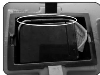
**3.4 -** Acomode o chicote da bateria e o chicote principal na parte lateral da bateria (conforme imagem).
