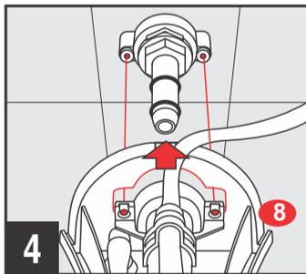
4 Alinhe os dois orifícios do Chassi(8) com os dois orifícios do conjunto rosqueado na conexão hidráulica.
