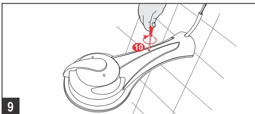
Com o auxílio de uma chave fenda/Phillips, aperte o Parafuso (10) fixando o Acabamento no Chassi.
