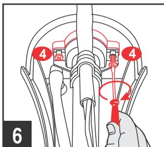
Com o auxílio de uma chave fenda/phillips, aperte os dois parafusos (4) fixando o Chassi nos componentes fixados na conexão hidráulica.
