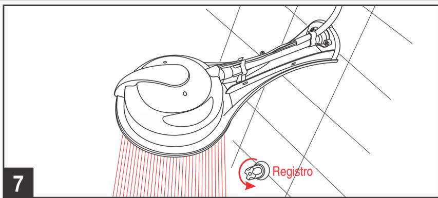
Abra o registro e deixe a água escorrer por alguns segundos. Essa operação tem a finalidade de encher o Bojo (11), para evitar danos à Resistência e verificar se há vazamentos. **Em caso de vazamento, corrija o mesmo antes de prosseguir com a instalação.**
