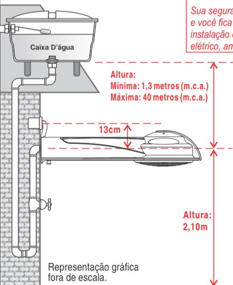
**PRESSÃO HIDRÁULICA MÍNIMA DE FUNCIONAMENTO:** 13 kPa (1,3 m.c.a.\*)
