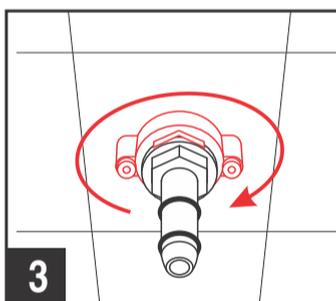
Com o auxílio de uma chave Fixa de 1" (não acompanha o produto), rosqueie o Niple de entrada (2) juntamente com o Fixador (3) na conexão hidráulica. **Antes de prosseguir para o próximo passo, cheque o alinhamento horizontal dos componentes fixados (Figura 3b).**
