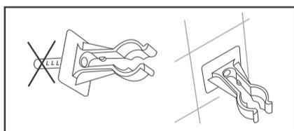
Também é possível instalar o Suporte sem furar a parede, basta retirar com uma ferramenta adequada a bucha do mesmo e aplicar fita dupla face de alta aderência (não acompanha o produto).
