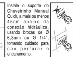
Também é possível instalar o Suporte sem furar a parede, basta retirar com uma ferramenta adequada a bucha do mesmo e aplicar fita dupla face de alta aderência (não acompanha o produto).
