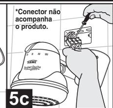
Coloque o Isolador dos condutores de ligação (13) e como mostra o destaque 5a, utilize o sulco do Super Cano para encaixar o conjunto (cabos + aterramento + isolador) da Super Ducha Quattro, passando pelo acabamento do mesmo e pela "placa" (se houver) 5b. Ligue os cabos, utilizando preferencialmente "Conectores FAME que deve ser bem apertado e colocado dentro da caixa de derivação 5c. Tampe a caixa com a placa (se houver) e parafuse-a.
