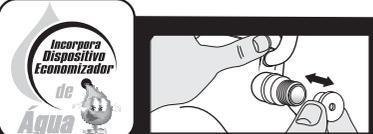
Verifique a altura da coluna d'água do aparelho em relação a caixa d'água. Se for maior que 5 metros mantenha o Economizador "Redutor", se for menor retire o Economizador.
