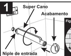
Limpe a saída de água onde será instalado o Super Cano para eliminação de eventuais sujeiras. Verifique o diâmetro da conexão hidráulica, que deve ser de 1/2".
