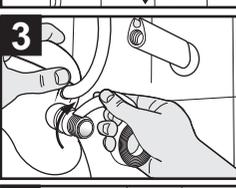
Aplique fita veda rosca no niple de entrada da Super Ducha Quattro. Confira se a chave seletora está na posição (0) desligada.
