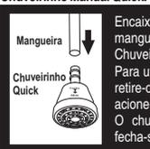
Encaixe uma das extremidades da mangueira no pino de entrada do Chuveirinho. Para utilizar Chuveirinho Manual Quick, retire-o do Suporte, abra o Registro e aione-o. O chuveirinho abre-se, puxando-o e fecha-se empurrando-o.
