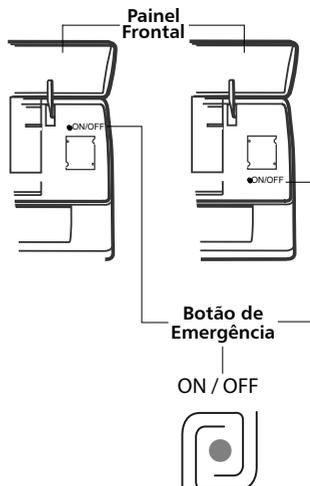
**⚠** A forma e a posição do botão de emergência podem ser diferentes de acordo com o modelo, mas sua função é a mesma.
