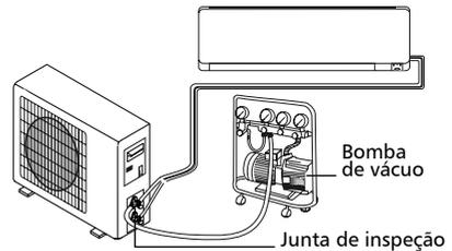
1. Solte a tampa de proteção das válvulas das linhas de líquido e de sucção.
