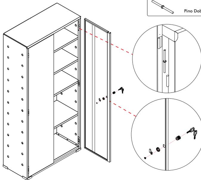
Encaixe os pinos das dobradiças nas laterais, depois encaixe as portas. Finalize montando o puxador e fechadura, em seguida regule os pés de acordo com o piso.
