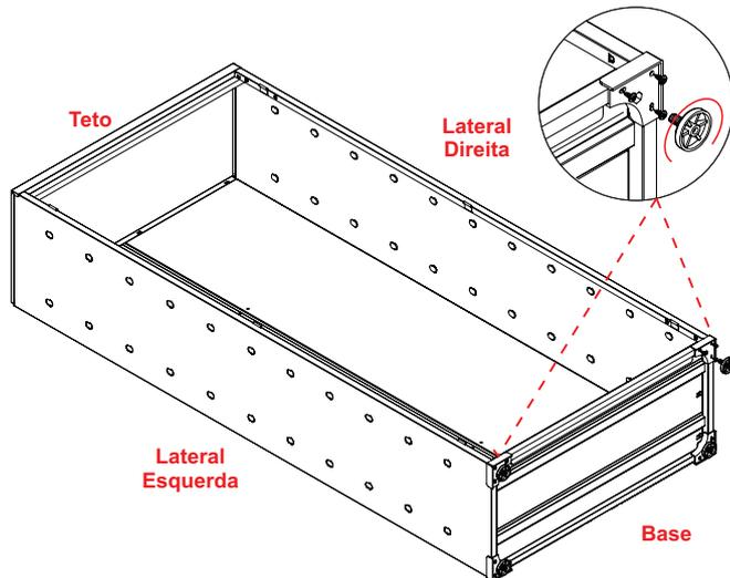
Com armário deitado encaixe o suporte do pé e parafuse, em seguida rosqueie o pé e nivele-o conforme sua necessidade.
