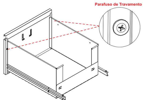
Após encaixadas todas as gavetas no corpo do arquivo, confira o alinhamento das mesmas, em seguida faça o travamento com os parafusos.
