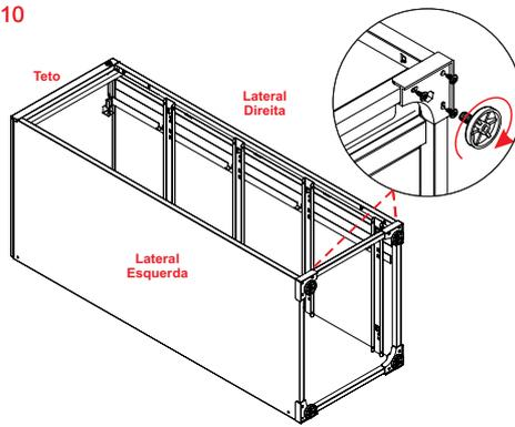
Com o arquivo deitado encaixe os pés, parafuse e nivele-o de acordo com sua necessidade.
