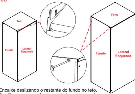
Encaixe deslizando o restante do fundo no teto. Certifique-se que o fundo esteja bem encaixado. Em seguida com o auxílio de uma chave philips, empurre os clicks superiores para dentro e dobre de forma que as partes fiquem bem travadas.
